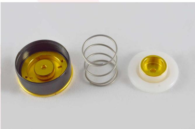
Entnehmen Sie die verbaute Feder und tauschen Sie diese dann gegen die andere aus. Der Zusammenbau erfolgt in umgekehrter Reihenfolge. Beachten Sie beim eindrehen der Isolatorscheibe, dass die Gewinde richtig ineinander greifen. Die Gewinde der Kunststoffscheibe sind relativ empfindlich.
