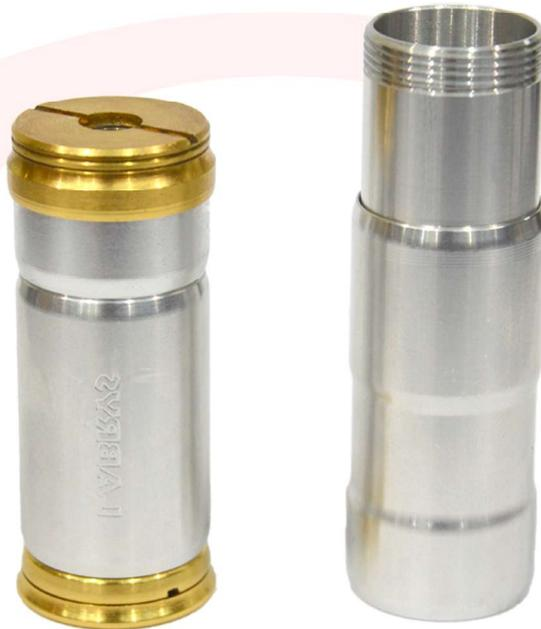
Legen Sie die Akkus immer mit dem Pluspol in Richtung des Verdampfers ein. Besonders wichtig ist das korrekte Einlegen der Akkus, wenn Sie den Labrys im Stacking betreiben wollen. Im Stacking ist es zwingend nötig, dass die jeweiligen Pole der Akkus in die gleiche Richtung zeigen. Tun Sie dies nicht, wird die falsche Anordnung zu einem Kurzschluss führen.
